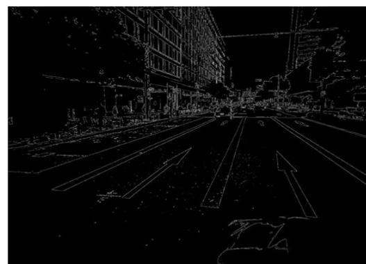
図7 カメラ画像(上)とCanny法適用結果(下)
