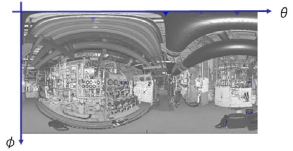
図3. メルカトル図法による点群画像
