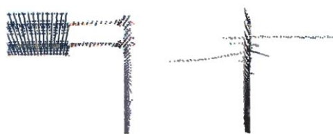
図 5 標識の点群（左）電線がついた電柱（右）
