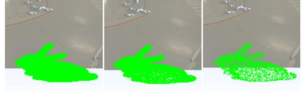
図5 メッシュモデル(左)と点群モデル(5000点)(右)の投影結果
