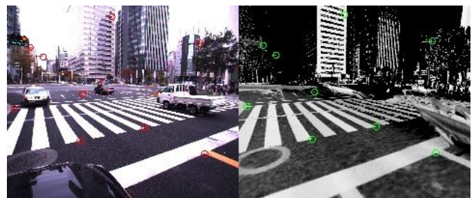
図9 検証点(右:緑)と検証点の射影変換による投影点(左:赤)
