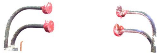
図 2 一般化円筒を含む工業設備点群
