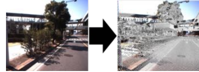
図2 点群のカメラ画像への投影
