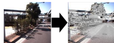
図3 点群のカメラ画像への投影
