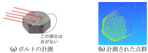
図4 ボルトの点群
