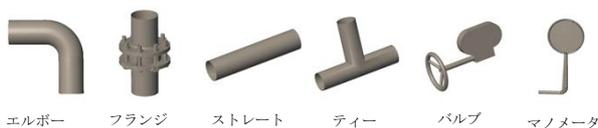
図 1. 部材認識に用いる部材
