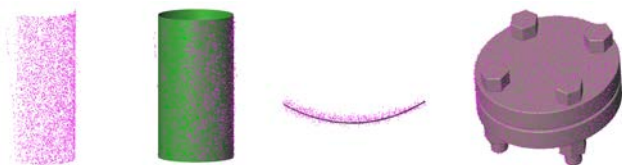
(a) 実測点群 (b) 円柱計算 (c) 残差の算出 (d) ノイズ付加 図 4 CAD から生成される点群へのノイズ付加
