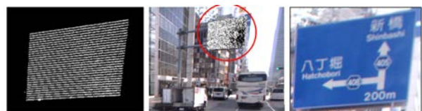
(a) 標識の点群 (b) 画像への投影 (c) 画像の抽出 図3 点群に対応する画像の抽出
