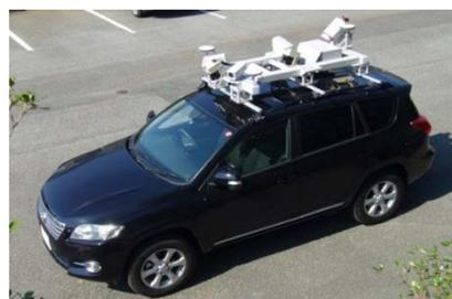
図1 移動計測装置(MMS)
